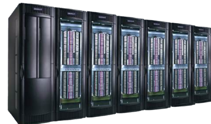
«СЕЛЕНГА.ARХИВ». Ультра-высокая плотность в формате 19-дюймовой стойки с двумя роботами и масштабированием до 16 000 слотов
