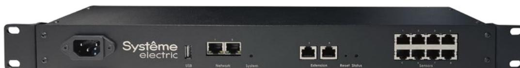
SystemeBotz — масштабируемая система активного мониторинга, предназначенная для защиты помещений, технологического и ИТ-оборудования от различных факторов риска, к которым относятся: физическое воздействие, изменение параметров микроклимата, протечки, возгорания и задымления, инциденты и аварии на инженерном оборудовании и другое.
