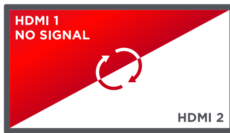
Автоматический переход на резервный источник
